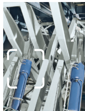
Theaterhubpodium Stufenloses Halten der Bühnenposition
