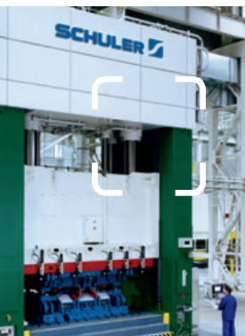
Hydraulische Presse Absturzsicherung als DGUV Test zertifizierte mechanische Hochhalteeinrichtung
