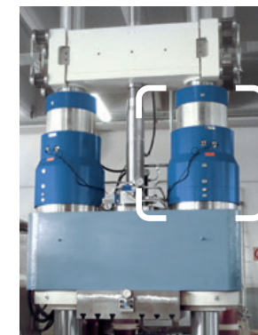
Hydraulische Innenhochdruckpresse Erzeugen von 400 Tonnen Schließkraft
