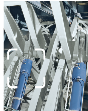
무대 지지장치 무단으로 어떠한 위치에서든지 장치 설비 지지 가능
