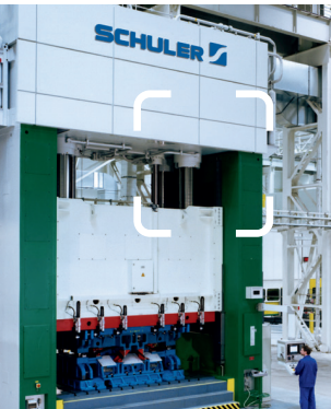
유압프레스 DGUV 안전 승인 Safety Catcher 장착
