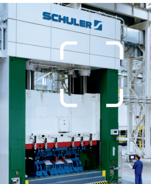
液压压机 经德国工伤保险行业协会 (DGUV) 认证的安全保护器
