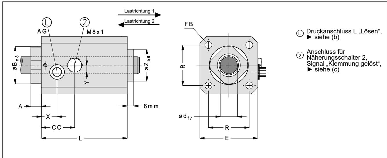
Abb. 2: Abmessungen Feststelleinheit KFPA, S-Typ, für den Einsatz mit separater Stange (Download von CAD-Daten: [www.sitema.com](http://www.sitema.com))
