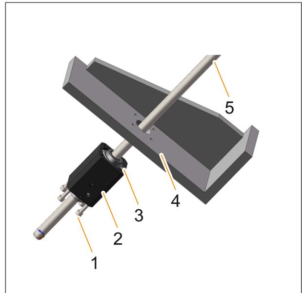
Abb. 4: S-Typ, Befestigung mit separater Stange
