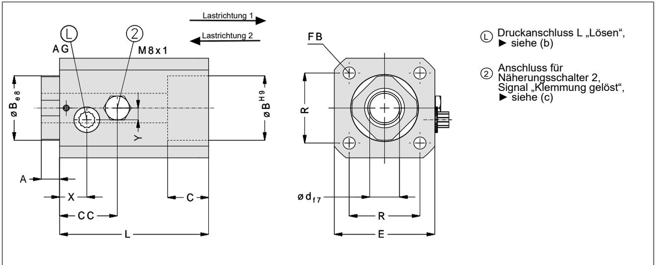
Abb. 1: Abmessungen Feststelleinheit KFPA, Z-Typ, für den Einsatz mit Normzylinder (Download von CAD-Daten: [www.sitema.com](http://www.sitema.com))
