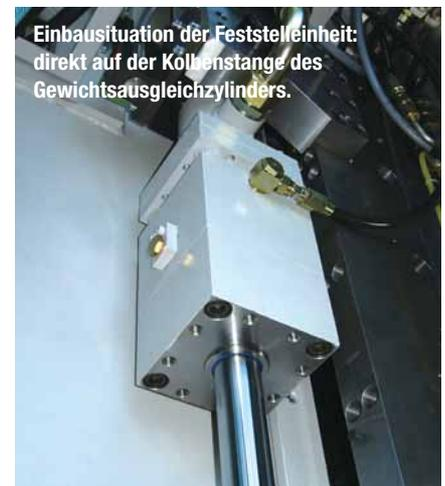
Einbausituation der Feststelleinheit: direkt auf der Kolbenstange des Gewichtsausgleichszylinders.
