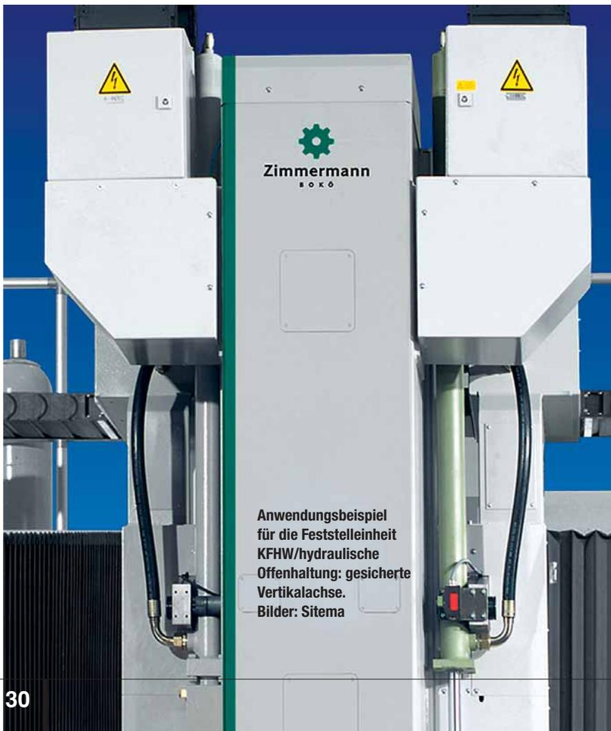
Anwendungsbeispiel für die Feststelleinheit KFHW/hydraulische Offenhaltung: gesicherte Vertikalachse.
