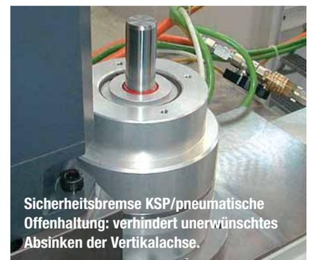
Sicherheitsbremse KSP/pneumatische Offenhaltung: verhindert unerwünschtes Absinken der Vertikalachse.
